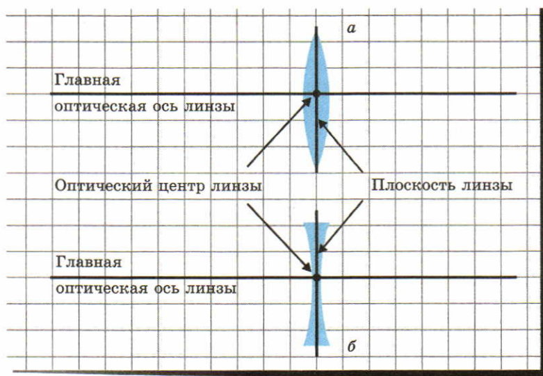
Рис. 16. Основные элементы линзы: a — собирающая (выпуклая) линза; б — рассеивающая (вогнутая) линза
