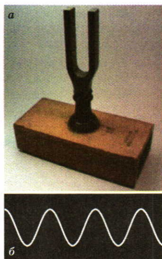
Рис. 17.3. Камертон (а) и запись звуковых колебаний (б)
