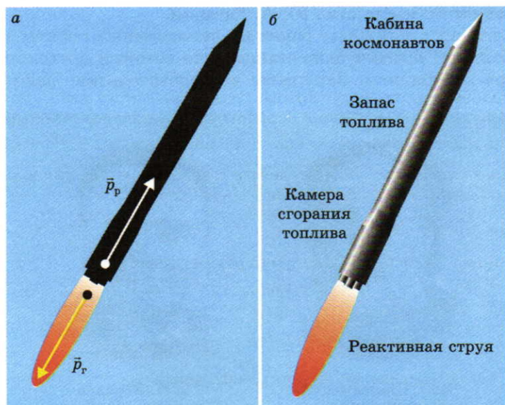
Рис. 12.3. Ракета: а — принцип действия; б — схема устройства
