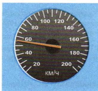
Рис. 2.4. Спидометр — прибор, указывающий мгновенную скорость автомобиля
